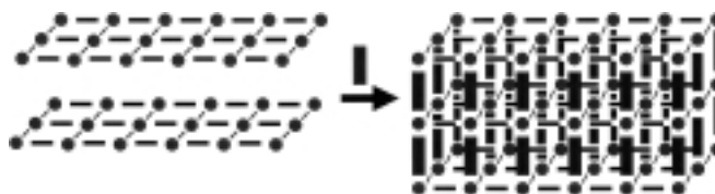
Schema 1. Von quadratischen Gittern zu Oktaederpolymeren. ● oktaedrische Einheit (z. B. Metallzentrum), — linearer bifunktionaler Ligand, ■ weiterer linearer Ligand (z. B. Anion).
